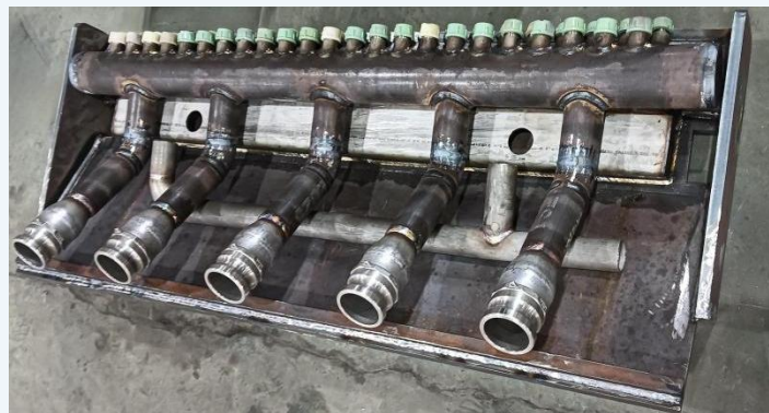
六辊单机工作辊喷射及吹扫集成
