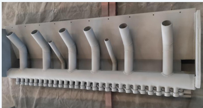
六辊单机工作辊喷射及吹扫集成
