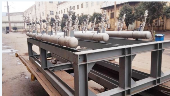
喷雾抑尘现场调试
