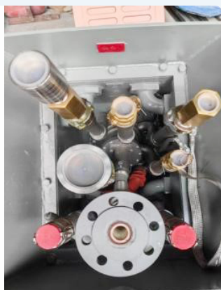
● 法液空空气助吹混合燃烧氧枪 （石钢130吨电炉）
