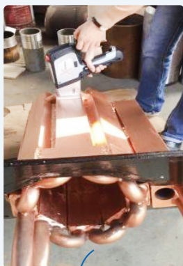
● 康卡斯提多功能氧枪水冷盒（马钢110吨电炉）
