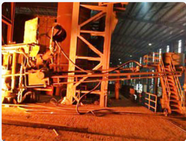
● 全套自耗式炉门氧枪系统（东方特钢现场）
