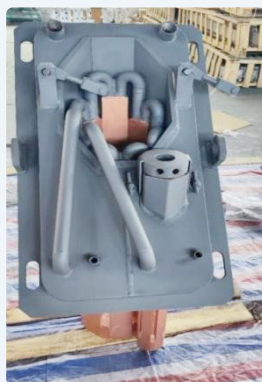
● 康卡斯提多功能氧枪水冷盒（马钢110吨电炉）
