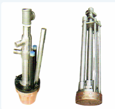
● 康卡斯提多功能氧枪水冷盒（马钢110吨电炉）
