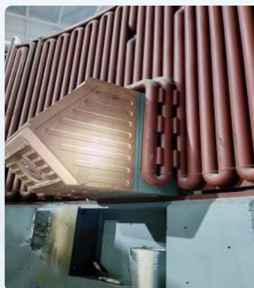
● 法液空空气助吹混合燃烧氧枪 （石钢130吨电炉）
