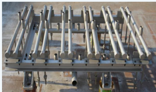
宝钢板坯二冷喷淋框架
