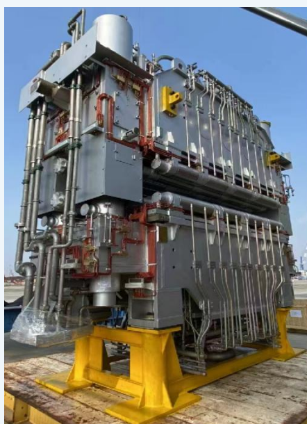
JFE(仓敷)7号机板坯喷淋管
