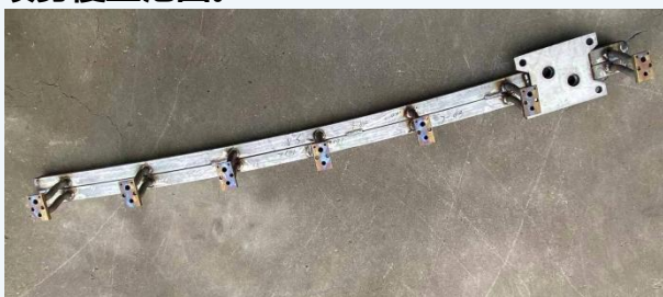
方坯二冷喷淋管
