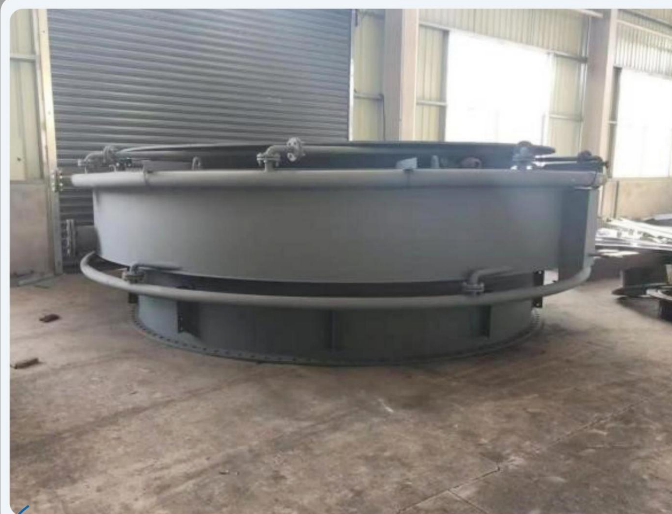
● 中铁转炉煤气一次湿法除尘溢流水盆
