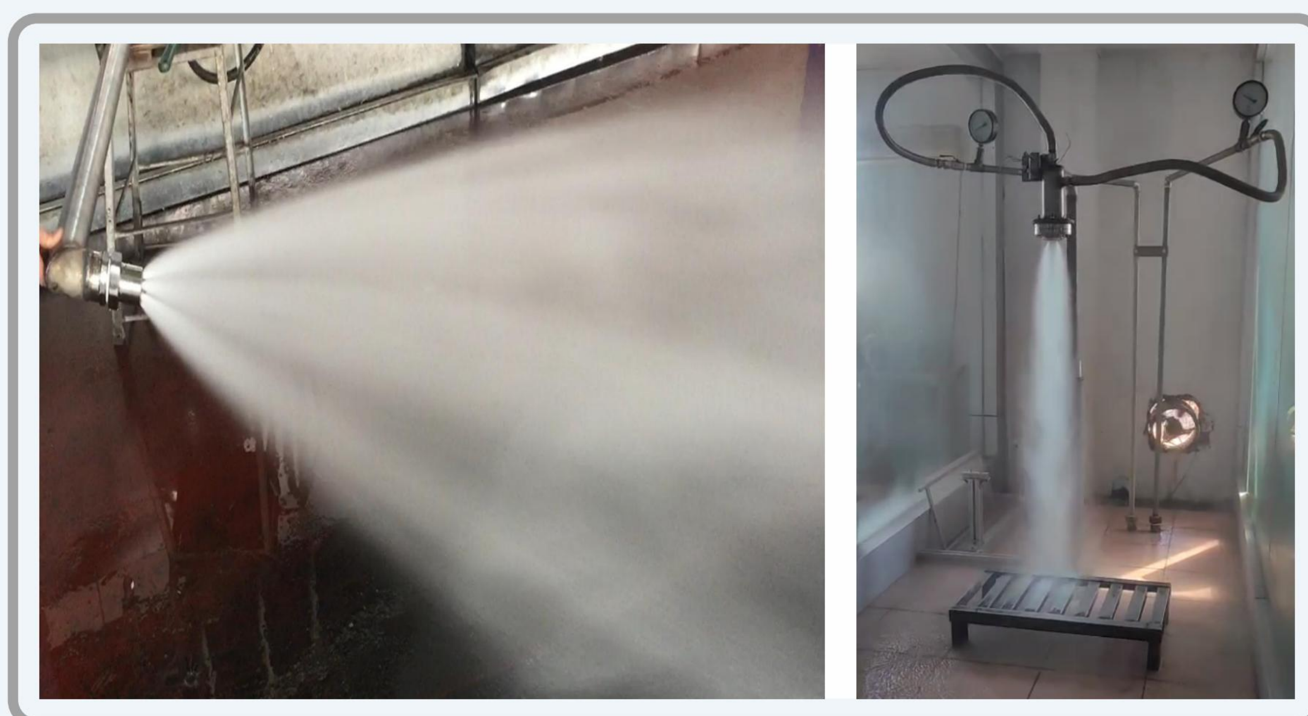
测试中心进行喷枪雾化效果模拟测试
