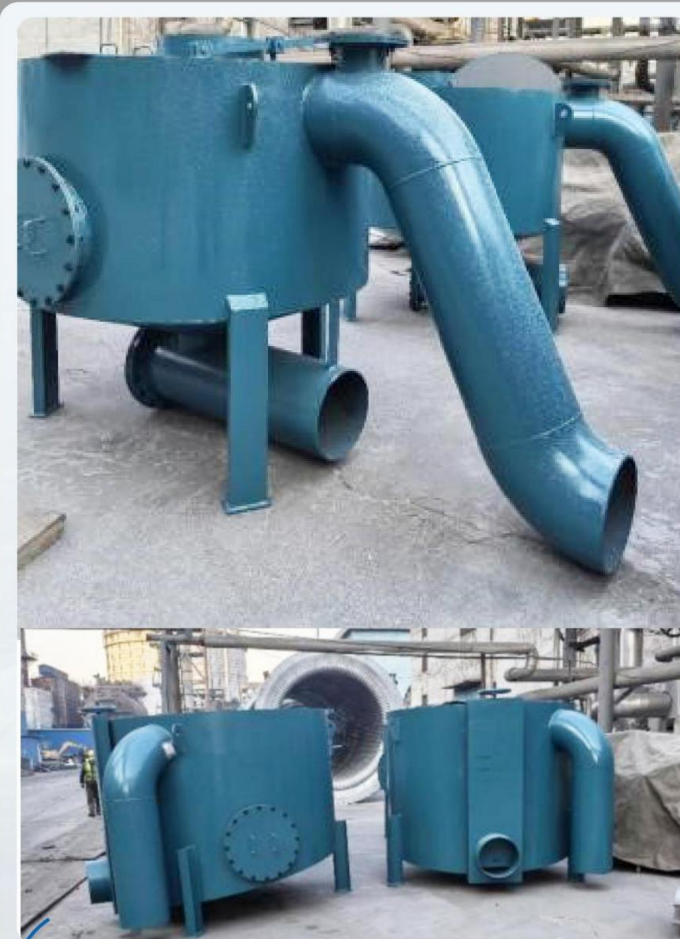
● 中铁转炉钢渣除尘水封排水器
